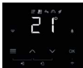
3,5-palcový 7-segmentový displej s dotykovými tlačidlami
